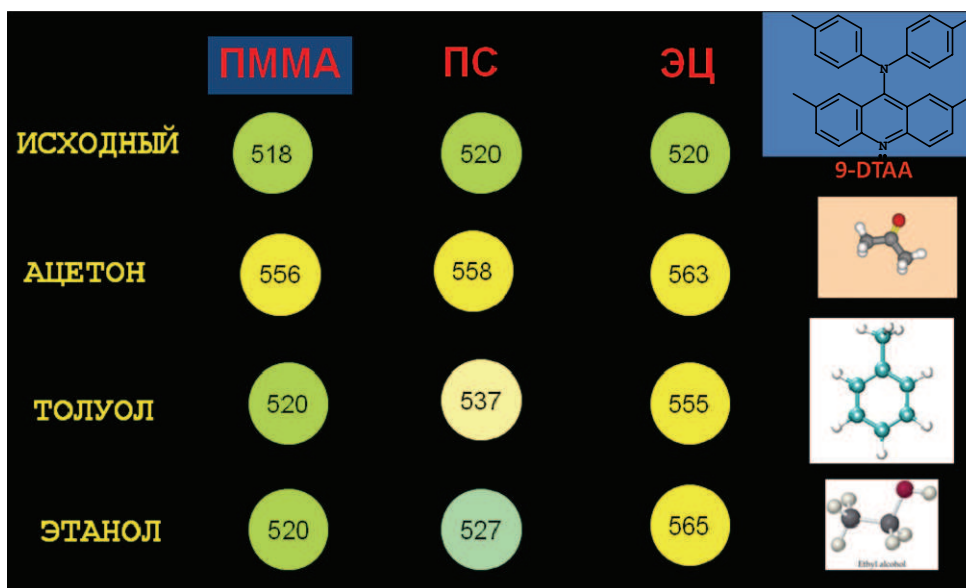
Рис. 3.21. Схематическое изображение матрицы флуоресцентных сенсорных элементов на основе 9-ДТАА и полимерных матриц. Числами обозначены максимумы полос флуоресценции, окраска кругов символизирует цвет флуоресценции элементов.
