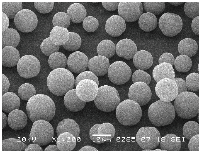
Рис. 4.11. SEM-фотография монослоя силикагельных частиц, иммобилизованных на клейкой основе из акрилового латекса.
